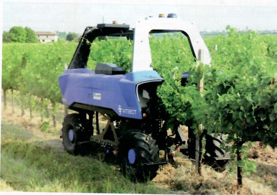
**Foto 1** Vitibot Bakus presente a Vite in Campo 2021: è dotato di un pacco batterie da 80 kwh che gli garantisce 10-12 ore di autonomi
