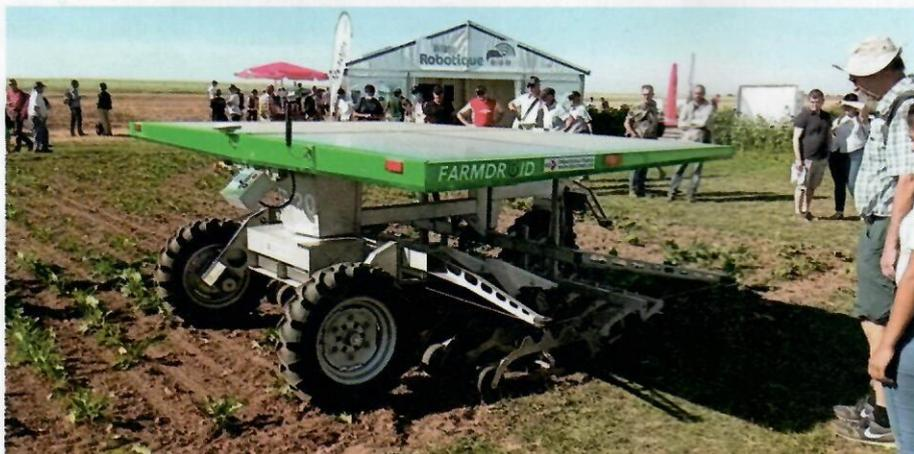
**Foto 5** Robot Farmdroid per la semina e la gestione meccanica automatica delle infestanti su colture orticole e seminativo (presente a Innovagri)
