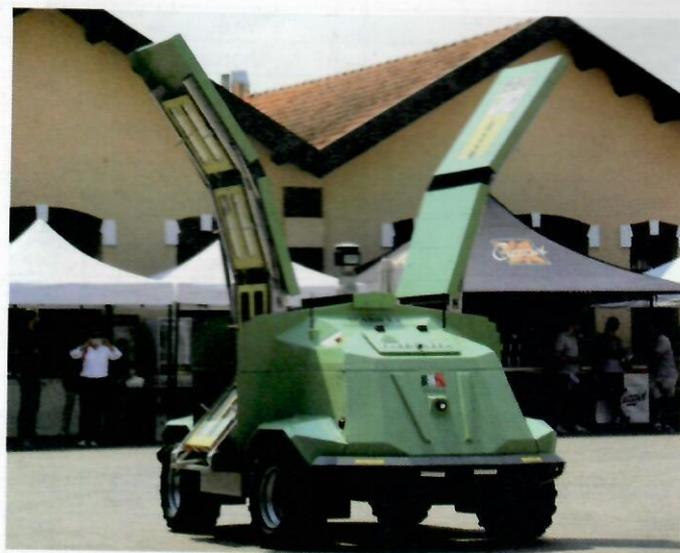
**Foto 2** Icaro X4 presente a Vite in Campo 2021: attraverso l'utilizzo di UVC promette di rendere più sostenibile la lotta ai principali patogeni fungini della vite
